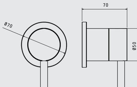
Miscelatore bidet in acciaio inox AISI 316L, finitura satinata, cartuccia Ø 25 mm. Completo di flessibili di connessione.
